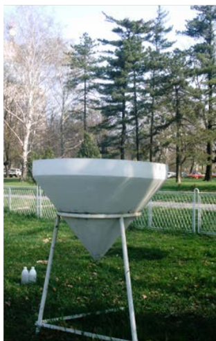
Slika 2. Levak za sakupljanje uzoraka padavina u Karadorđevom parku
