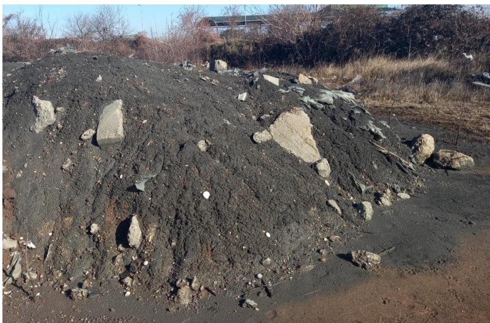
Slika 2: Izgled otpadnog taloga od prečišćavanja rastvora od neutralnog luženja, odnosno sirovine za proizvodnju kadmijuma, odloženog na otvorenom.
