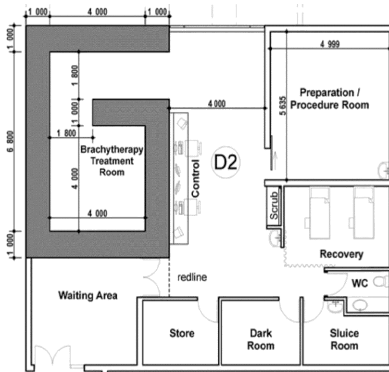
Slika 2. Brahiterapijski bunker sa ostalim prostorijama (predlog IAEA; direktno preuzeto).[1]
