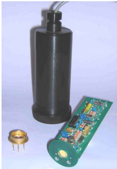
Slika 3. Fotodiode u standardnom pakovanju (levo), izgled alfa sonde (u sredini) i konstrukcija alfa sonde sa standardnom fotodiodom koja se koristi kao detektor (desno)
