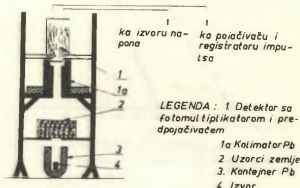
SLIKA 1. Šematski prikaz eksperimentalnog uređaja koji je korišćen za mereњe apsorpcije  $\gamma$ -zračenja u uslovima uskog snopa
