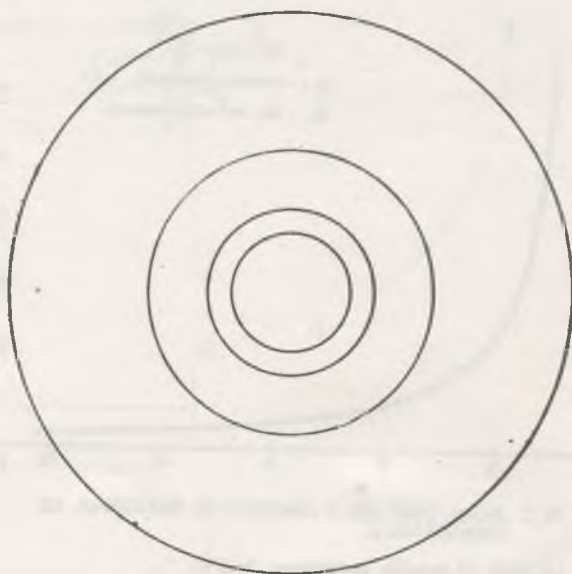
Sl.4. Radna glava sa kombinovanom zaštitom sa izvor 200 mCi Co-60.
