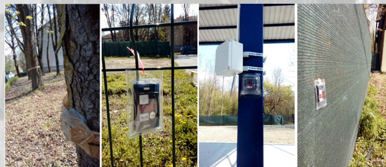
Slika 1. Različiti načini postavljanja TLD na platformi i van nje sa plastičnim zaštitama
