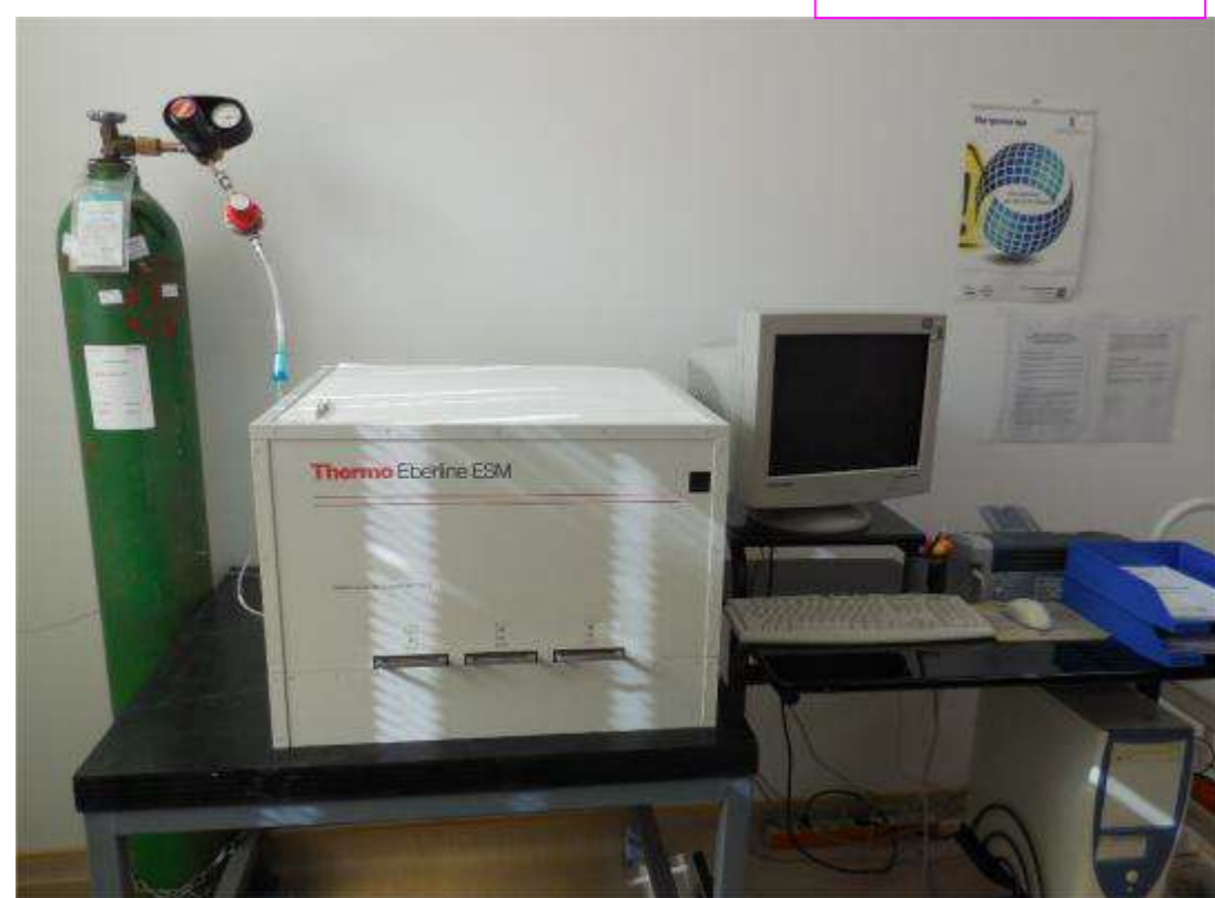
Gasnoi proporcionalni brojač THERMO-EBERLINE FHT 770T
