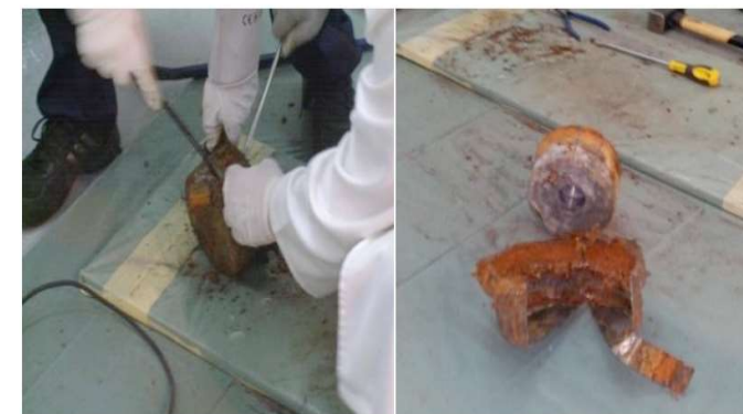
Слика 2. Вадње радиоактивног извора из гомобрана
